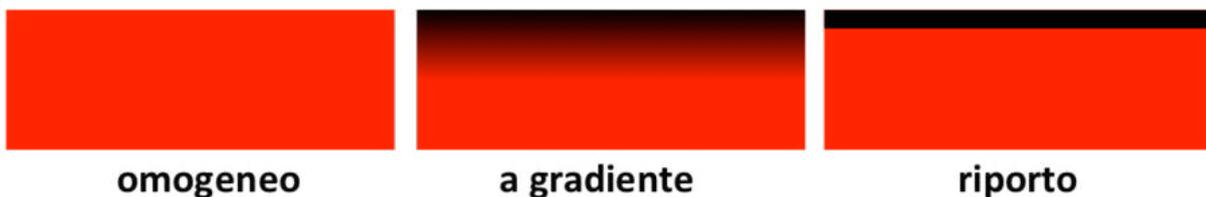
Figura I.4: Vista in sezione di un materiale omogeneo, con un gradiente compositivo, oppure con riporto.
